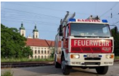
TLF A 4000/200 Tanklöschfahrzeug Steyr 16S26 Baujahr 1998
